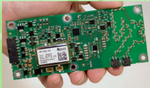
Naprava za nadzor izolacije meri izolacijsko impedanco med vodniki pod napetostjo (0 do 800 V DC in ozemljitvijo (maso vozila)
