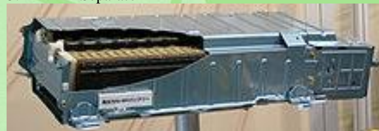
Visoko zmogljiv NiMH akumulator za Toyota Prius
