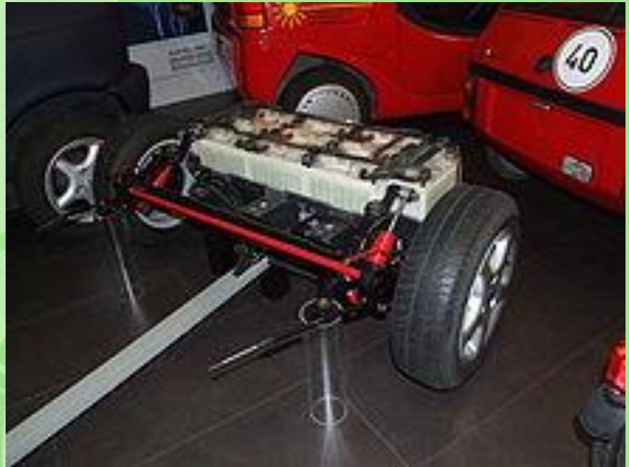
NiCd akumulator skupine PSA Peugeot Citroën – 100 Ah, 120 V, 300 kg
